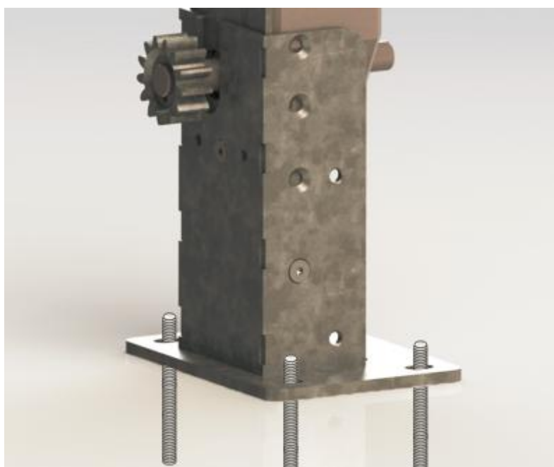
Rys. 7. Sposób montażu napędu na stopie betonowej.
